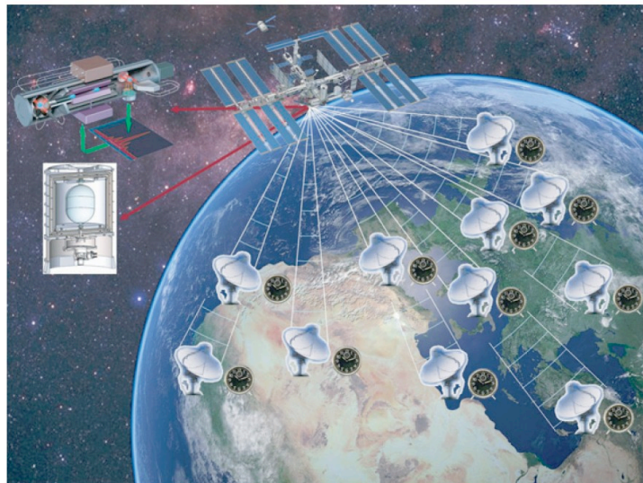
FIGURE 7 – La mission spatiale ACES de l'agence spatiale européenne. L'horloge PHARAO et un maser à hydrogène seront mis en orbite à bord de la station spatiale internationale en 2013. Des comparaisons de temps ultra-précises avec un réseau d'horloges au sol permettront d'effectuer des tests de physique fondamentale et relativité. Un récepteur GPS/GALILEO permettra également des applications en sciences de la terre et en navigation.
