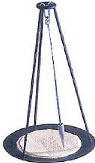
FIGURE 2 – Le pendule de Galilée/Huygens. Les petites oscillations du pendule sont indépendantes de l'amplitude du mouvement et sont remarquablement périodiques. En comptant le nombre d'oscillations du pendule, on mesure un intervalle de temps, réalisant ainsi une horloge. Plus la période du pendule est courte, plus élevé sera le nombre d'oscillations dans un intervalle de temps donné et plus précise sera la mesure de cet intervalle. Enfin, une formule simple relie la période des oscillations à la longueur du fil et à l'accélération de la gravité indiquant aussi les limites d'un tel dispositif, les variations de température et les variations de l'accélération de la pesanteur.
